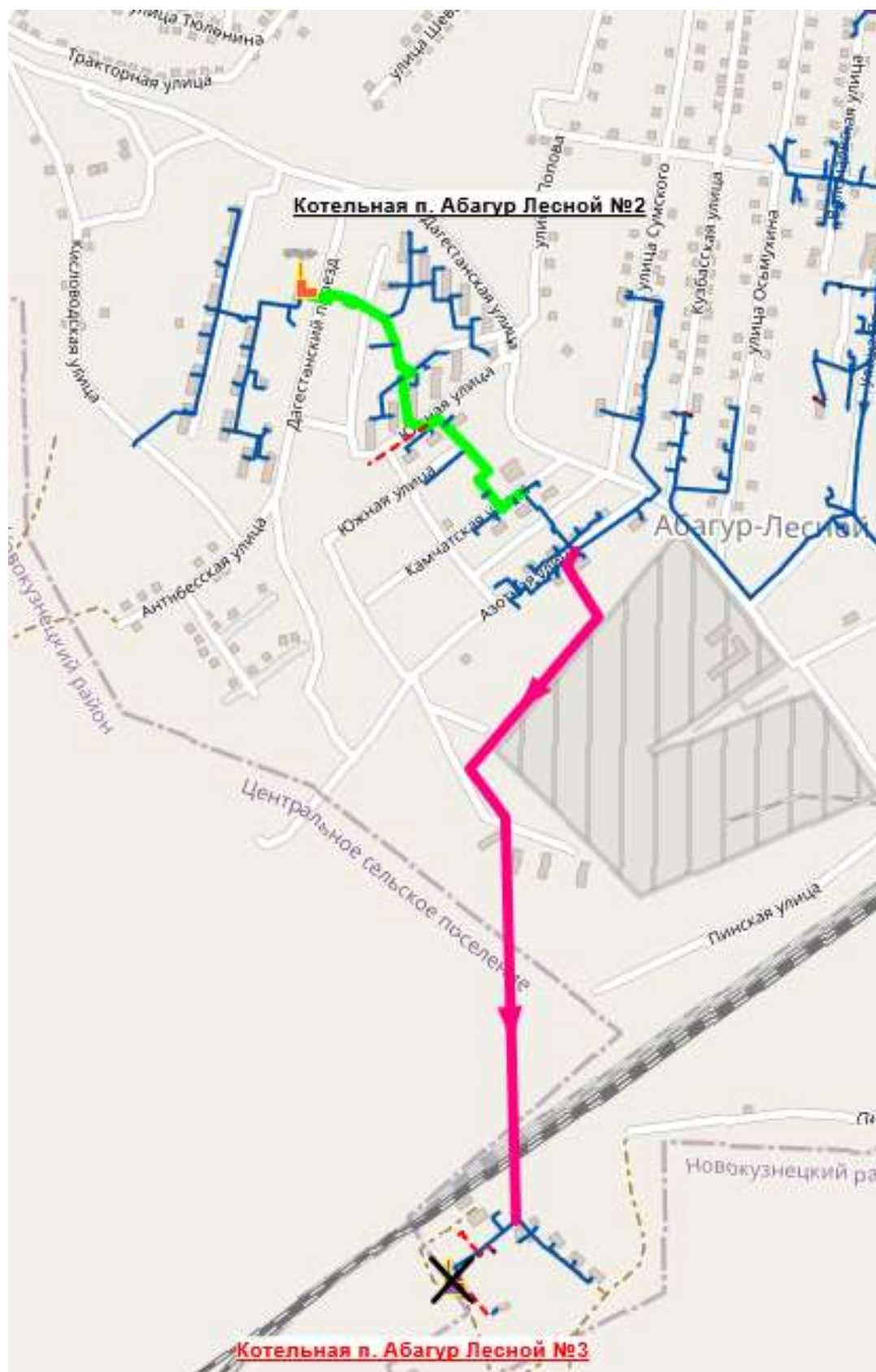
Рисунок 6.7 – Строительство тепловых сетей для переключения котельной №3 п. Абагур-Лесной на котельную №2 п. Абагур-Лесной
